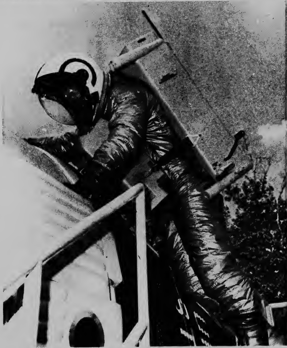
Hilton New di Dallas ta demostra aki un traje cu a ser deseña pa por move den espacio. E traje cu e aparatonan lo ser carga door di e astronautanan si nan tin cu bandona e nave espacial pa posible reparacion na e capsula. E aparatonan dilanti y patras di é; ta duna oxigenio radio y tin ta cohete chikito pa e por bai bin.
